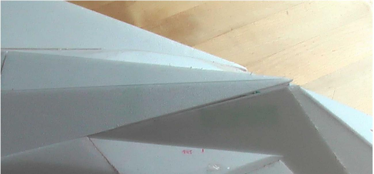
Das zuvor bearbeitete Bauteil "Abdeckung," an den Rumpf anpassen.
